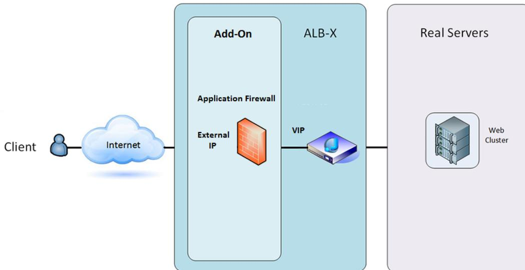
En esta arquitectura, sólo se puede utilizar HTTP para su servicio ya que el Firewall no puede inspeccionar el tráfico HTTPS.
