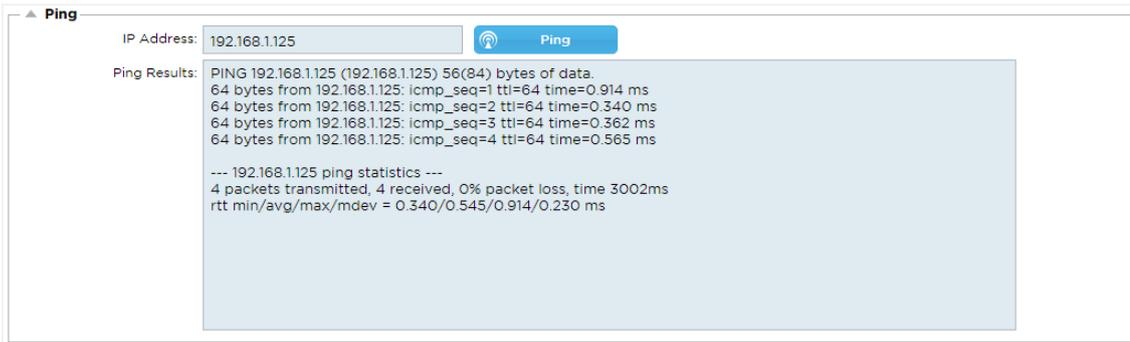
Escriba la dirección IP del host que desea probar, por ejemplo, la puerta de enlace por defecto utilizando la notación decimal con puntos o una dirección IPv6. Es posible que tenga que esperar unos segundos para que el resultado se muestre una vez que haya pulsado el botón "Ping".
