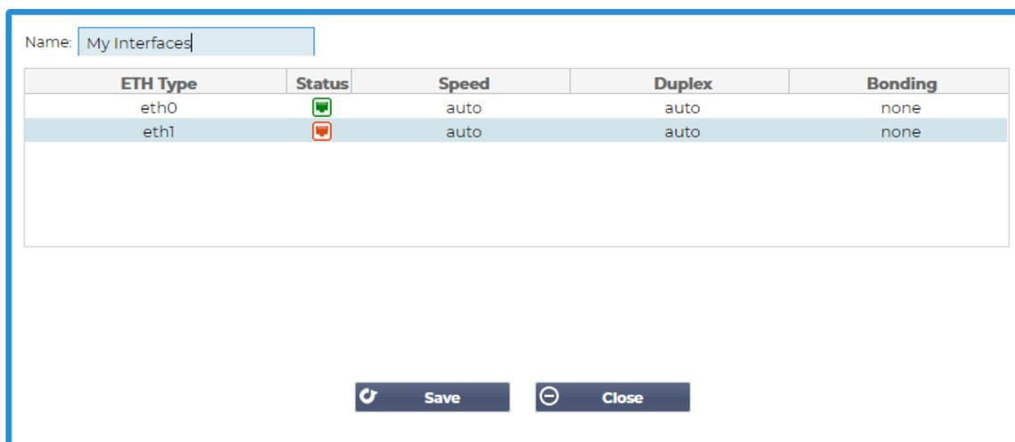
El widget Interfaz permite mostrar los datos de la interfaz de red elegida, como ETH0, ETH1, etc. El número de interfaces disponibles para la adición depende de cuántas interfaces de red haya definido para el dispositivo virtual o aprovisionado dentro del dispositivo de hardware.
