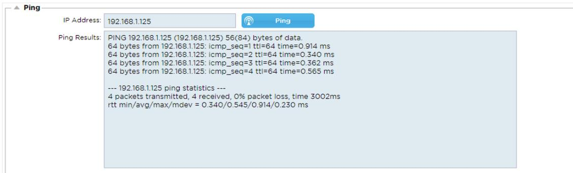
Digite o endereço IP do host que você deseja testar, por exemplo, o gateway padrão usando uma notação decimal pontilhada ou um endereço IPv6. Você pode ter que esperar alguns segundos para que o resultado seja respondido uma vez que você tenha pressionado o botão "Ping".
