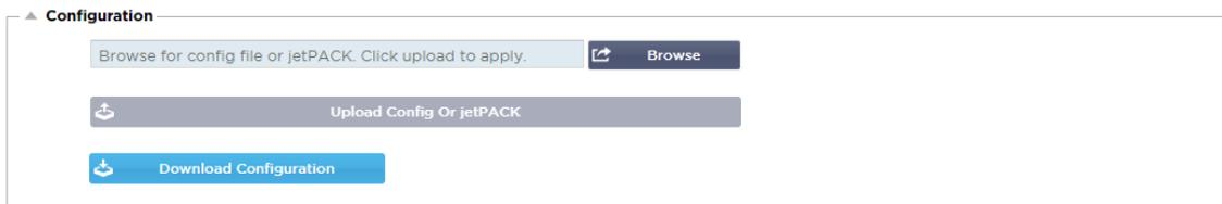
Siempre es una buena práctica descargar y guardar la configuración del CAD una vez que esté completamente configurado y funcionando como se requiere. Puede utilizar el módulo de configuración tanto para descargar como para cargar una configuración.
