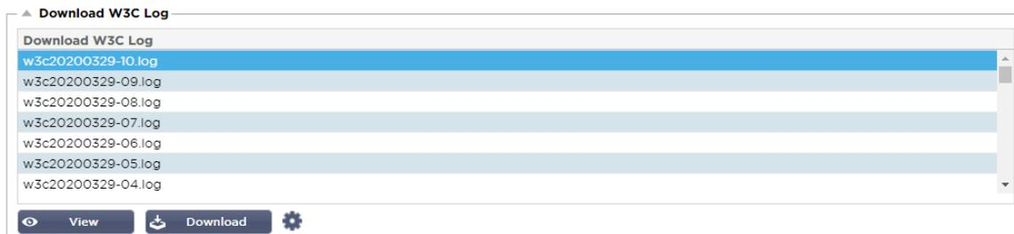
Die W3C-Protokollierung wird über den Abschnitt System > Protokollierung aktiviert. Ein W3C-Protokoll ist ein Zugriffsprotokoll für Webserver, in dem Textdateien erzeugt werden, die Daten über jede Zugriffsanforderung enthalten, einschließlich der Quell-Internetprotokoll-(IP-)Adresse, der HTTP-Version, des Browsertyps, der Verweisseite und des Zeitstempels. W3C-Protokolle können sehr groß werden, abhängig von der Menge der Daten und der Kategorie der Protokollierung, die aufgezeichnet wird.
