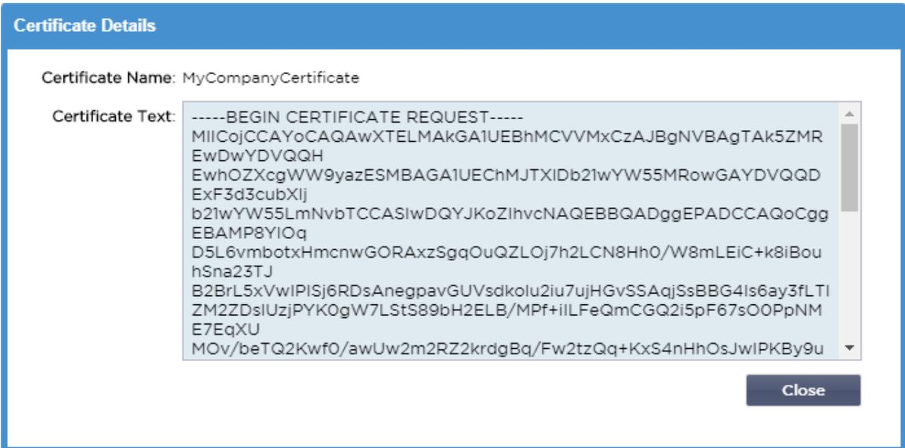
Sie müssen den Inhalt ausschneiden und in eine TEXT-Datei einfügen und diese mit einer CSR-Dateierweiterung benennen, z. B. *mycert.csr*. Diese CSR-Datei müssen Sie dann Ihrer Zertifizierungsstelle zur Verfügung stellen, um das SSL-Zertifikat zu erstellen.
