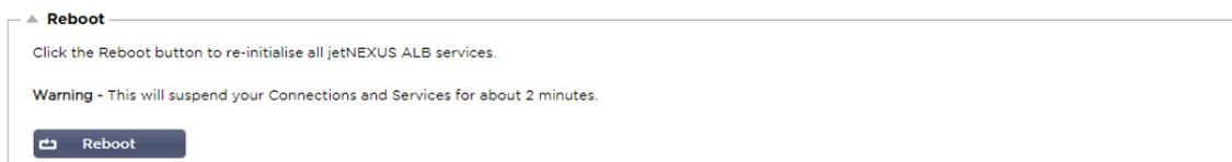
点击 "重启 "按钮将对ADC进行电源循环，并自动使其恢复到活动状态。将会显示一个弹出窗口，要求确认重启行动。
